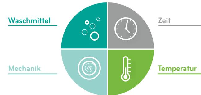
Wird einer dieser Faktoren verändert, z. B. die Temperatur, dann muss der Anteil mindestens eines anderen Faktors entsprechend erhöht werden, um dieselbe Waschleistung zu erzielen. Eine Verlängerung der Waschdauer hilft daher, auch bei geringerer Temperatur eine gute Waschleistung zu erzielen:
